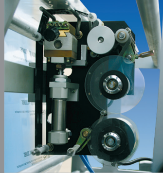
Ribonlu Sıcak Tarih Basma Makinesi / Ribon Type Hot Coding Printer Machine dateuse à ruban / Печат даты рибонная طابعة تاريخ
